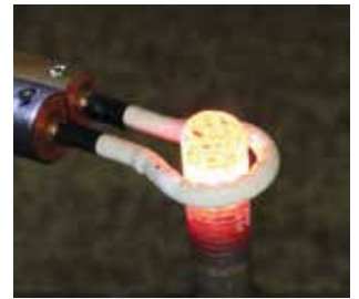
› Erwärmen eines Gewindebolzens mit der wassergekühlten Spule
