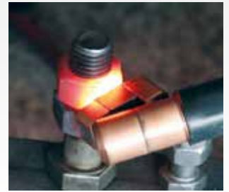
› Erwärmen einer Mutter mit der Fokusspule schräg
