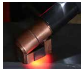
› Erwärmen eines Bauteils mit der Fokusspule schräg
