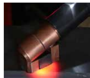
› Erwärmen eines Bauteils mit der Fokusspule schräg
