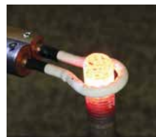
› Erwärmen eines Gewindebolzens mit der wassergekühlten Spule
