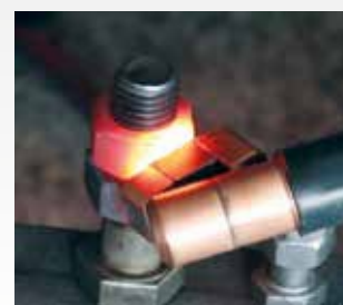
› Erwärmen einer Mutter mit der Fokusspule schräg
