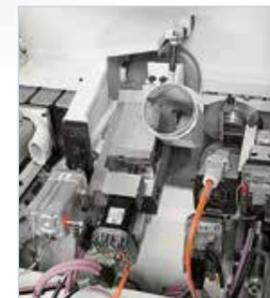
**R-HP Radius- und Fasefräsaggregat**
